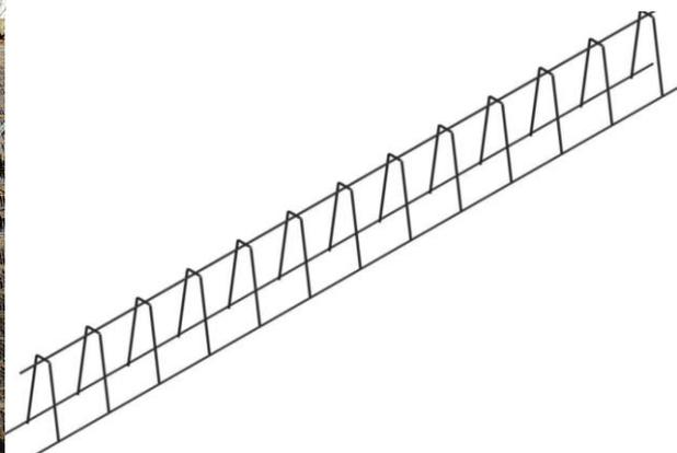
Permettent de maintenir l'espacement nécessaire entre les armatures du béton et la peau des coffrages.
