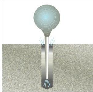
Souffler 4 fois à l'aide de la pompe manuelle ou de la buse à air comprimé. Brosser 4 fois puis souffler à nouveau 4 fois. Pour des trous de diamètre supérieur à 14 mm, utiliser exclusivement la brosse adaptable sur une perceuse fournie avec le kit d'installation.
