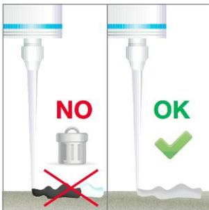
Après avoir vissé la canule sur la cartouche et inséré celle-ci dans le pistolet approprié, presser sur la gâchette et jeter les premiers cm jusqu'à l'obtention d'un mélange homogène.
